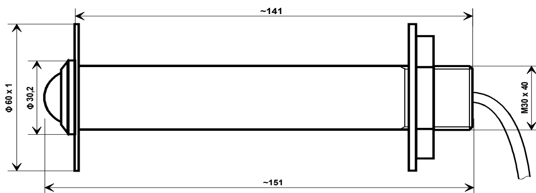
Rys. 14. Rysunek gabarytowy lampki wandaloodpornej.
